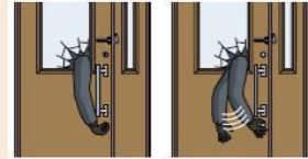
従来のサムターン セキュリティサムターン(取り外した状態)
